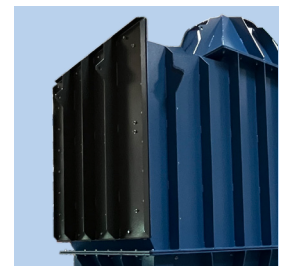
Frontlåge for let adgang til udskiftning af Hardox plader boltet på inderside af råluftkammer
