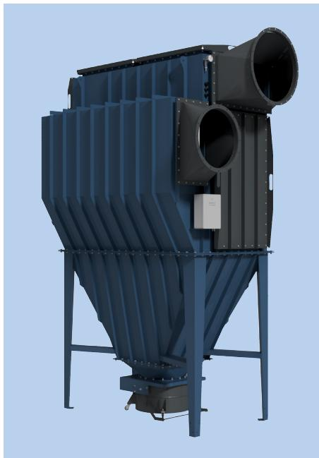
Energioptimeret anlæg til større filtreringsopgaver. Anvendes til filtrering af slibestøv, blæse-/slyngrensningsstøv, skærerøg og støvfuldt luft indeholdende metal, sten, plast osv. eller fra håndtering af diverse pulvermix. Anlæg konstrueret for anvendelse ved ATEX-zonerne 21-22 og standard forsynet med en aflastningsmembran, beregnet til at bryde ved en eksplosion, hvorved anlæg aflastes og eksplosioner kontrolleres.
