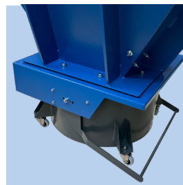
Entleerung in 70L oder 148L Eimer und Zellenradschleuse für Big-Bag
