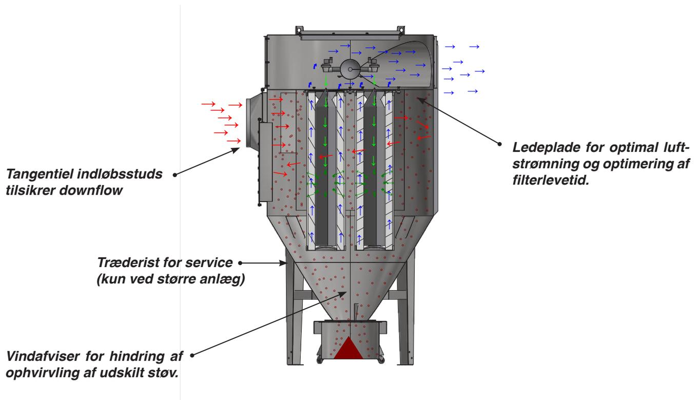
Principskitse for flow for cyklonfilter type ACF-T-A / -T-V-A / -T-A-HO:
