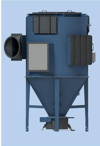
Energioptimeret anlæg til større filtreringsopgaver, hvor der er risiko for støveks-plosioner, f.eks. ved filtrering af aluminiumsstøv, træstøv eller støv fra håndtering af diverse pulverblandinger. Anlægget konstrueres til anvendelse i ATEX-zonerne 21-22 og er standard forsynet med en aflastningsmembran, beregnet til at bryde ved en eksplosion, hvorved anlægget aflastes og eksplosionen kontrolleres.
